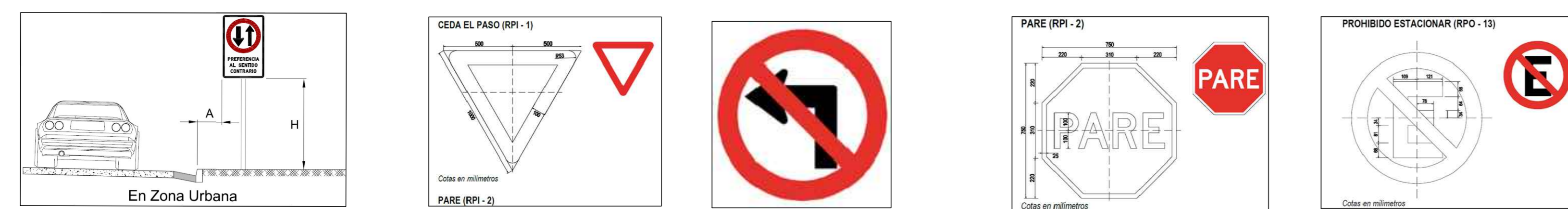
DETALLE SEÑALIZACIÓN VERTICAL
